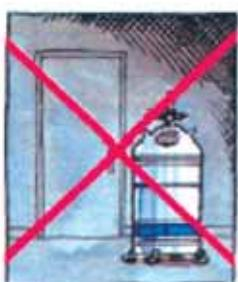
3. Δεν αποθηκεύουμε ποτέ το δοχείο σε κλειστούς χώρους. Το δοχείο υγρού αζώτου πρέπει πάντα να τοποθετείται κάθετα σε χώρο προστατευμένο και καλά αεριζόμενο
