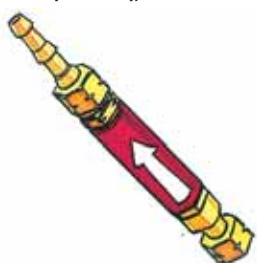
Χρησιμοποιούμε τις βαλβίδες αντεπιστροφής/ φλογοπαγίδες
