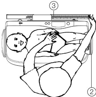
2. Met de rechter hand de voetsteun (2) in de richting van de voeten van de zuigeling schuiven, daarbij de voeten van de zuigeling op de voetsteun leggen. Met de linkerhand de zuigeling op de schaal van de weegschaal fixeren.
