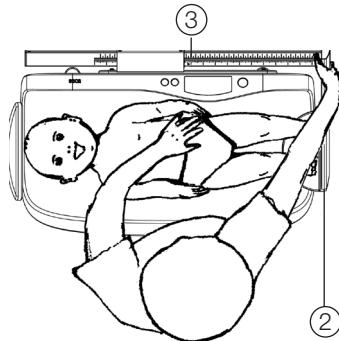
2. Avec la main droite, faire glisser le support de pieds (2) en direction des pieds du nourrisson, de sorte que ses pieds soient posés à plat sur la plaque. Avec la main gauche, maintenir le nourrisson dans la cuvette de la balance.
