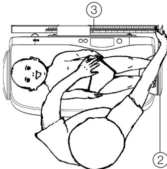
2. Med højre hånd skubbes fodstøtten (2) hen mod barnets fødder, derved skal barnets fødder lægges på fodstøttens ligeflade. Med venstre hånd holdes barnet fast på vægtens fordybning.
