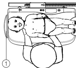
1. Das Kleinkind auf die Waagenmulde legen. Der Kopf des Kleinkindes muss am Kopfanschlag (1) der Mulde liegen.
