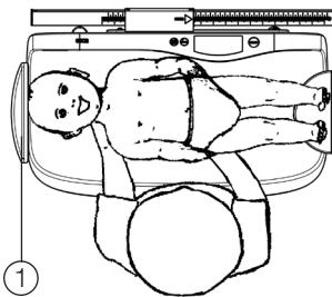
1. Τοποθετείτε το βρέφος στο κοίλωμα της ζυγαριάς. Το κεφάλι του βρέφους πρέπει να εφάπτεται στο σημείο αναστολής (1) του κοιλώματος.
