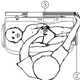
2. Med den høyre hånden skyves fotstøtten (2) i retning av spedbarnets føtter og spedbarnets føtter legges på fotstøttens hvileflate. Med den venstre hånden holdes spedbarnet på plass i vektens fordypning.
