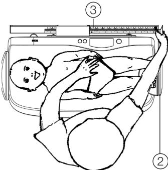
2. Mit der rechten Hand die Fußstütze (2) in Richtung der Füße des Kleinkindes schieben, dabei die Füße des Kleinkindes auf dem waagerechten Halbkreis der Fußstütze ablegen. Mit der linken Hand das Kleinkind auf der Waagenmulde fixieren.
