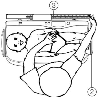
2. Σπρώχνετε με το δεξί χέρι το στήριγμα ποδιών (2) προς την κατεύθυνση των ποδιών του βρέφους και τοποθετείτε ταυτόχρονα τα πόδια του βρέφους πάνω στην επιφάνεια του στηρίγματος ποδιών. Με το αριστερό χέρι σταθεροποιείτε το βρέφος πάνω στο κοίλωμα της ζυγαριάς.
