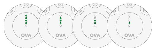
Bei einem Batteriestand von 20% und 10% ertönt ein Batteriewarnton und alle aktiven weißen LEDs blinken.
