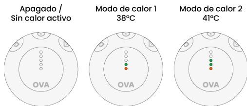
Una vez en el modo de terapia de calor, pulse repetidamente el botón de calor para alternar entre los modos de calor disponibles.
