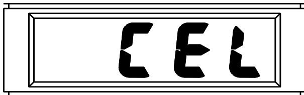
Наиболее вероятной причиной этого может быть истечение срока годности блока. Кроме этого, причиной может быть нажатие калибровочного переключателя без подачи газа. Убедитесь в корректной концентрации калибровочного газа (20 ppm), в надежности подключения газового баллона, в том, что баллон не пуст, и повторите калибровку.
