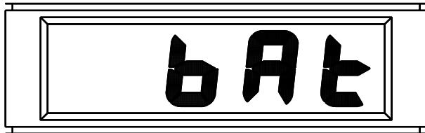
Wenn die Batterie vollständig entladen ist, wird die obige Meldung dauerhaft angezeigt und die Batterie muss gewechselt werden.
