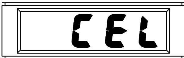
A causa mais provável para isso é a célula estar vencida, mas pode ser também resultado de se pressionar o interruptor de calibração sem nenhum gás ter sido aplicado. Certifique-se de que a concentração do gás de calibração está correta (20ppm), as conexões do cilindro de gás estão firmes e o cilindro de gás não está vazio; em seguida, repita o procedimento de calibração.
