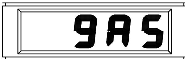
Schalten Sie das Gerät aus, wenn diese Anzeige vorliegt, entfernen Sie den Mundstück-Adapter und setzen Sie ihn 2 Minuten lang der Umgebungsluft aus, bevor Sie den Test wiederholen.
