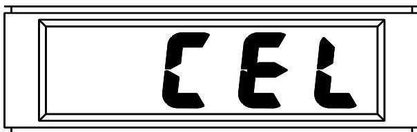
Il est possible que votre cellule soit arrivée en fin de vie, ou que le gaz de calibration n'ait pas été acheminé au moment où le bouton était pressé. Assurez-vous que la concentration du gaz de calibration est correcte (20 ppm), que les connexions à la bouteille de gaz sont bien sécurisées et qu'elle n'est pas vide, puis répétez la procédure de calibration.
