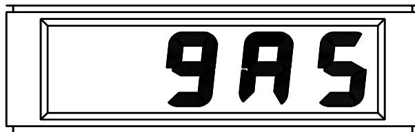
При появлении данного изображения следует выключить прибор, снять переходник загубника и дать к нему доступ окружающего воздуха в течение 2 минут, прежде чем повторять измерение.
