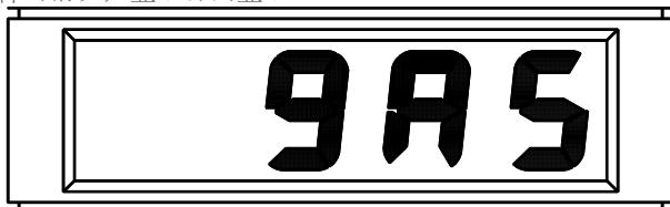
如果出现这样的显示，请关闭仪器，卸下咬嘴及咬嘴接口，将仪器放置在空气中2分钟后再进行测试。
