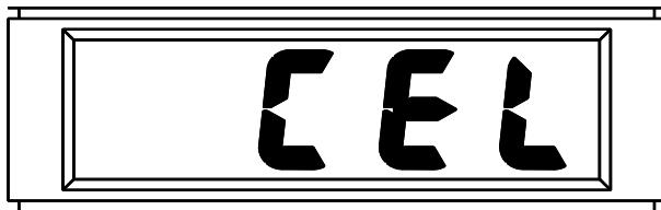
De meest waarschijnlijke oorzaak hiervan is dat het gaat om een vervallen cel, maar het kan ook zijn dat de kalibratieschakelaar is ingeduwd zonder dat er gas werd aangevoerd. Zorg dat de concentratie kalibratiegas correct is (20 ppm), dat de aansluitingen naar de gascilinder goed vastzitten, en dat de gascilinder niet leeg is. Herhaal vervolgens de kalibratieprocedure.
