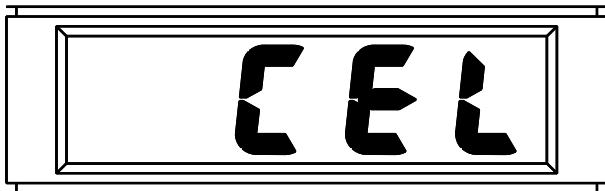
la causa più probabile è una cella esaurita ma ciò potrebbe anche essere dovuto alla pressione dell'interruttore di calibrazione senza l'applicazione del gas. Accertarsi che la concentrazione del gas di calibrazione sia corretta (20 ppm), che i collegamenti al cilindro del gas siano saldi e che il cilindro del gas non sia vuoto, quindi ripetere la procedura di calibrazione.
