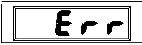
A causa mais provável para isso é o uso de uma concentração incorreta do gás de calibração. Certifique-se de que a concentração do gás de calibração está correta (20ppm), as conexões do cilindro de gás estão firmes e, em seguida, repita o procedimento de calibração.
