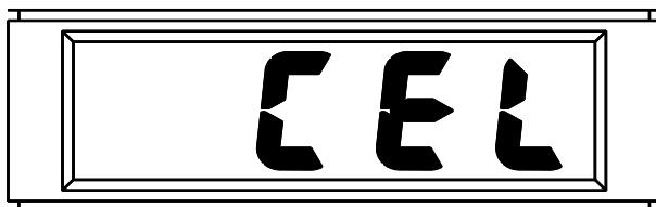
La causa más probable de que ocurra esto es una célula expirada, pero también puede producirse por pulsar el interruptor de calibración sin aplicación de gas. Compruebe que la concentración del gas de calibración es correcta (20 ppm), que las conexiones al cilindro del gas son seguras y que el cilindro del gas no se encuentra vacío; a continuación, repita el procedimiento de calibración.
