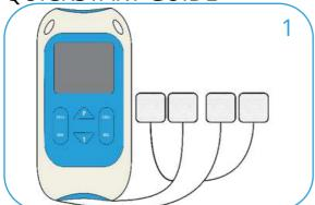
Connect the unit with the electrode pads Conecte el dispositivo a los parches Connectez l'appareil aux électrodes Verbinden Sie das Gerät mit den Elektroden
