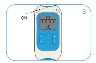
Press and hold the ON button to switch the device on Presione y mantenga el botón ON para encenderlo Appuyez sur le bouton ON pour allumer l'appareil Halten Sie die ON-Taste gedrückt, um einzuschalten
